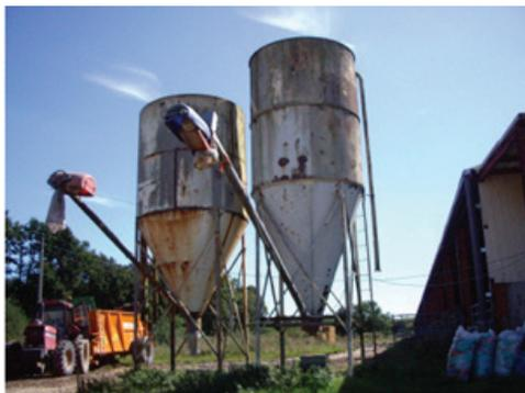
**Silos avec vis de chargement direct dans le bol.**
